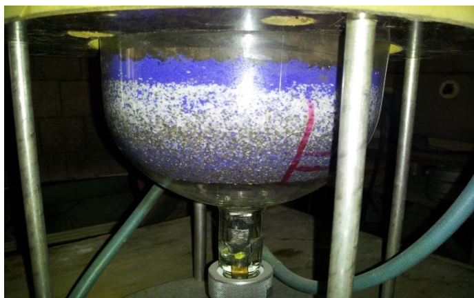
Рисунок – Фотография эксперимента по установлению зависимости полноты разделения компонентов сырья от их плотности
