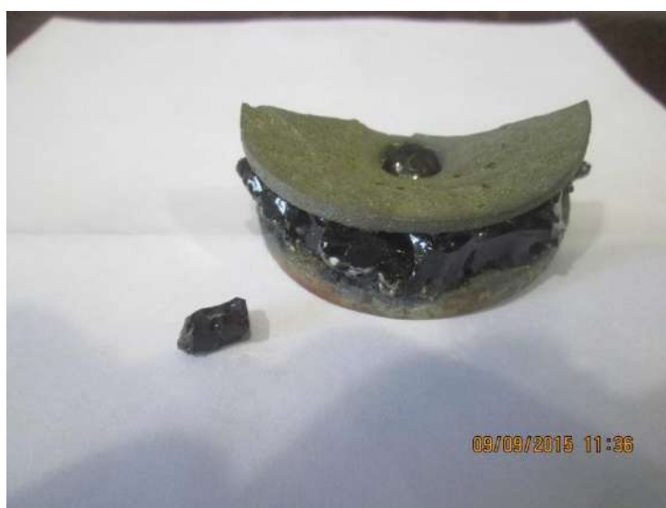
Рис. 2 Образец лётки из нитрида кремния, проработавшей 8 часов.
