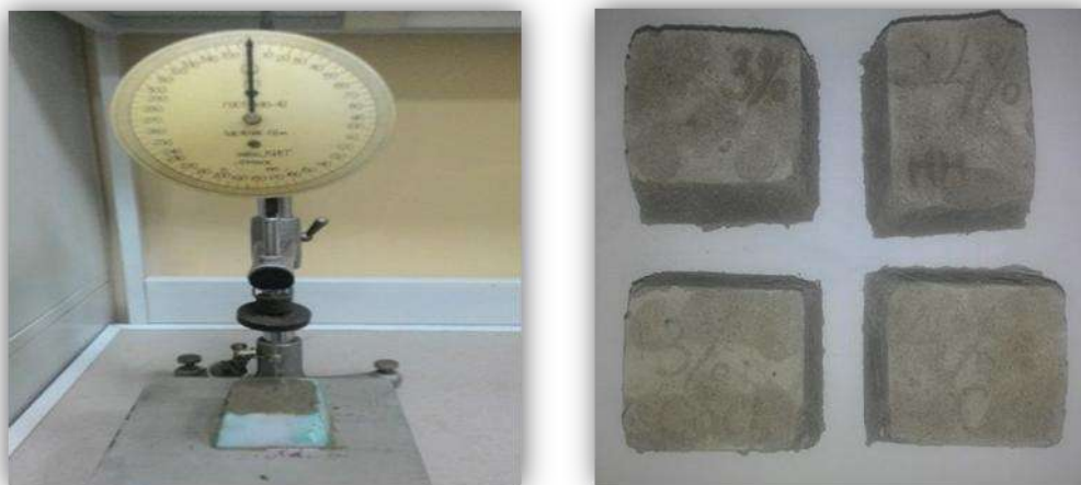
Рисунок 1 - Измерение времени схватывания цементного раствора с помощью прибора Вика
