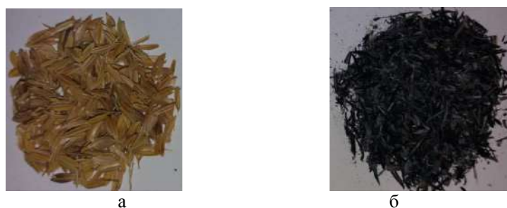
Рисунок 1 – Изображение исходной рисовой шелухи (а) и полученного графена (б)
