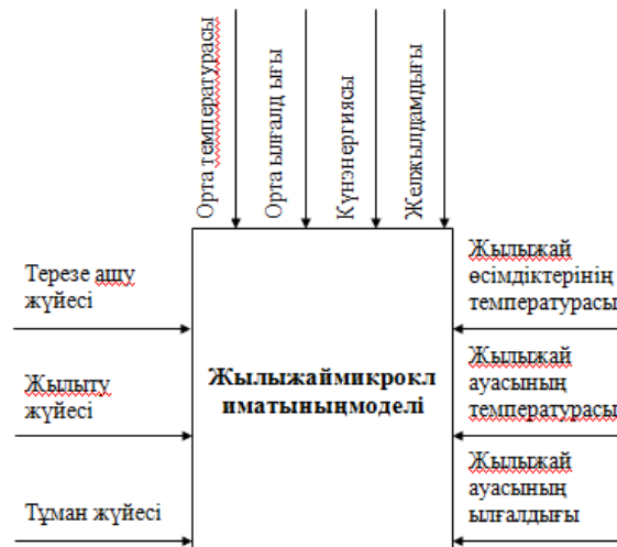
Сурет-1. Жылыжайдың температура-ылғалдық режимінің құрылымдық моделі
