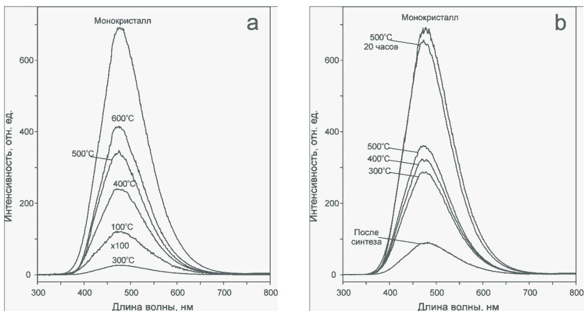
Рисунок 6 – Спектры фотолюминесценции порошка  $ZnWO_4$ , синтезированного при  $\sim 95^\circ C$  (a) и при  $180^\circ C$  (b), сразу после синтеза и после отжига, для разной температуры отжига, для сравнения приведен спектр ФЛ монокристалла  $ZnWO_4$ .
