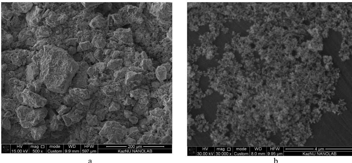
Рисунок 1 – SEM снимок порошков  $ZnWO_4$ , синтезированных при  $\sim 95^\circ C$  (a) и при  $180^\circ C$  (b)
