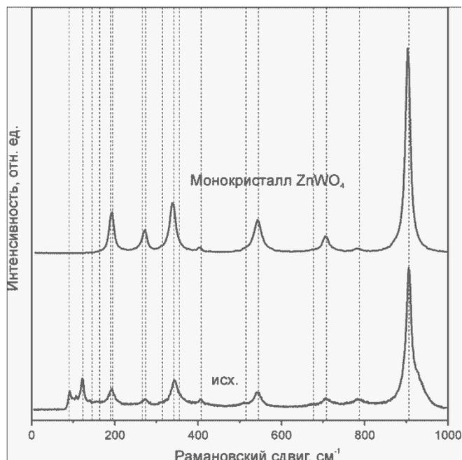
Рисунок 3 –Рамановский спектр образцов, синтезированных при 180°C, сразу после синтеза, для сравнения приведен спектр монокристалла, пунктирными линиями указаны положения рамановских полос ZnWO<sub>4</sub> по литературным данным [11].
