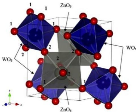
Рисунок 2 – кристаллическая структура вольфрамата цинка [10]
