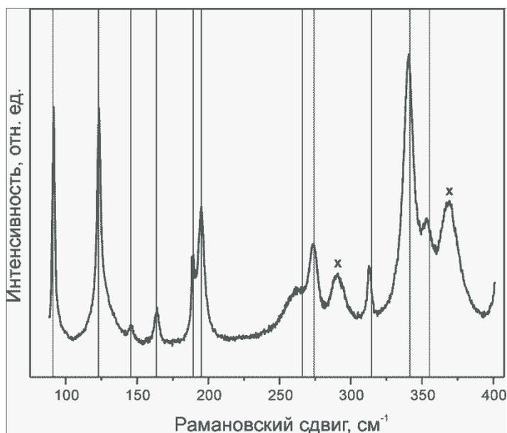
Рисунок 5 – Рамановские спектры порошков, синтезированных при  $\sim 95^\circ\text{C}$  и отожженных при  $600^\circ\text{C}$ , записанные с высоким разрешением, пунктирными линиями указаны положения рамановских полос  $\text{ZnWO}_4$  по литературным данным [11], пики, отмеченные крестиками (x), появляются из-за дефекта использованной дифракционной решетки и, возможно, являются гармониками линий при  $91$  и  $123\text{ см}^{-1}$ .
