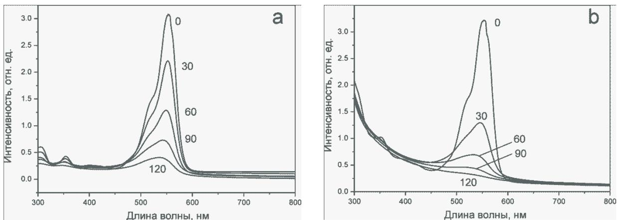
Рисунок 7 – Спектры поглощения водного раствора Родамин Б с порошком вольфрамата цинка синтезированного при ~95°C (а) и с порошками при 180°C при продолжительности облучения 0, 30, 60, 90, 120 мин.
