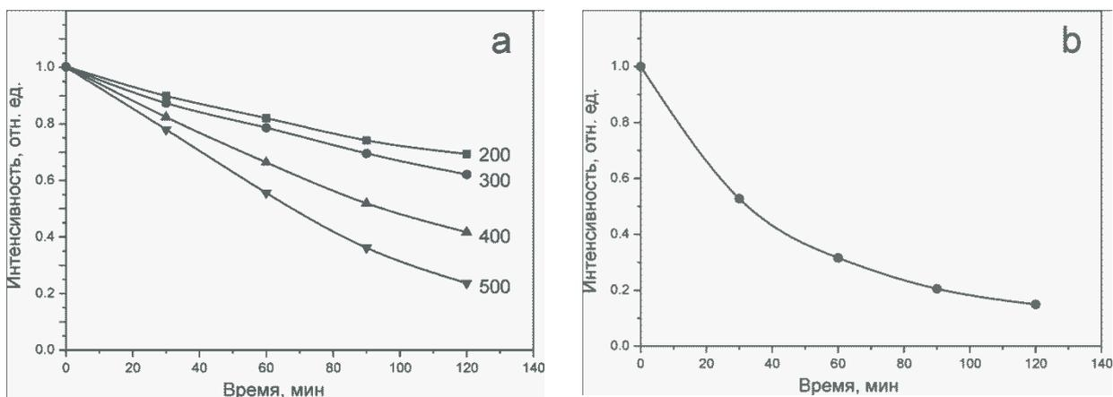
Рисунок 8 – Кинетические кривые фотокаталитического окисления водного раствора Родамин Б: а - с порошком, синтезированным при 95°C и отожжённым при разных температурах от 200 до 500°C, б – с порошком, синтезированным в автоклаве при 180°C.
