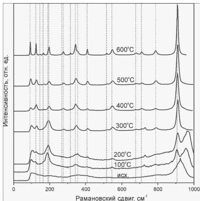
Рисунок 4 –Раман спектр образцов синтезированных при ~95°C и ожжённые при разных температурах отжига, пунктирными линиями указаны положения рамановских полос ZnWO<sub>4</sub> по литературным данным [11]
