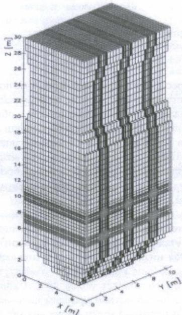
Рисунок 1 – Общий вид камеры сгорания котла ПК-39 и разбивка его на контрольные объемы
