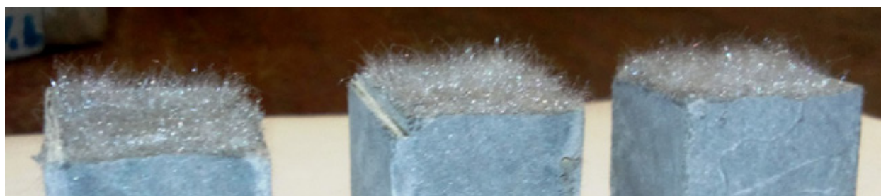
Рис. 2. Полипропиленовые волокна распределенные в матрице цементного камня
