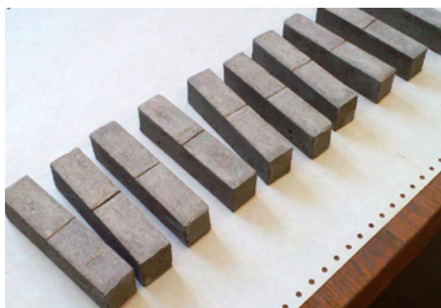
Рис. 5. Образцы цементного камня размерами 25×25×100мм с U-образным концентратором напряжений
