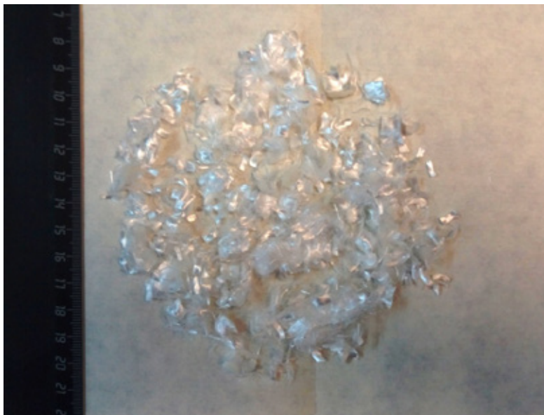
Рис. 1. Полипропиленовые волокна (фибра)
