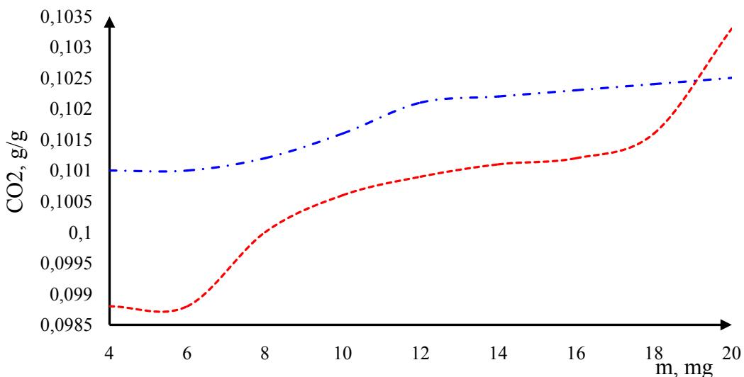
**Рисунок 3 – Распределение концентрации углекислого газа при горении октана  $C_8H_8$  и додекана  $C_{12}H_{26}$  в камере сгорания в зависимости от массы жидкого топлива**
