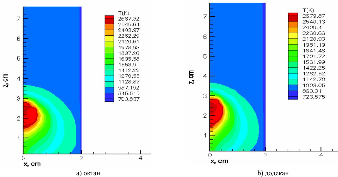
**Рисунок 5 – Профили температуры в камере сгорания
