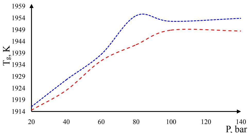
Рисунок 2 – Зависимость максимальной температуры октана  $C_8H_8$  и додекана  $C_{12}H_{26}$  от давления в камере сгорания (красная линия – октан, синяя линия – додекан)
