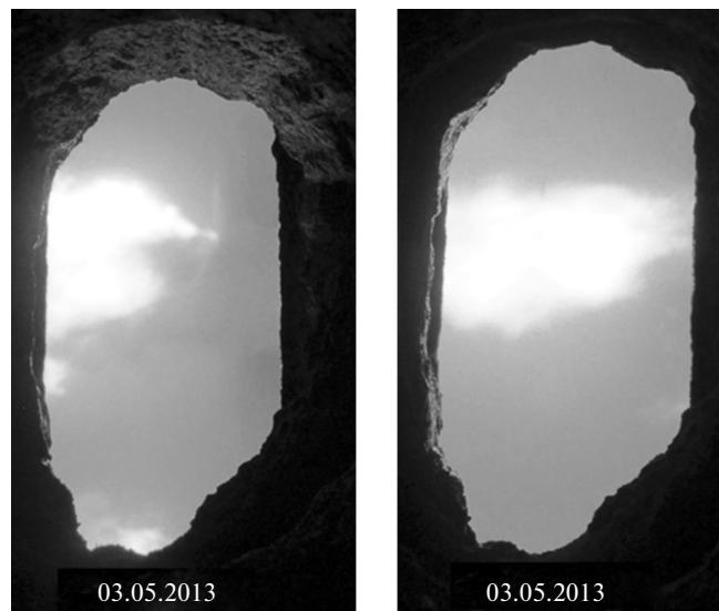
**Рис. 12.** Пылеугольный факел от ПТС в начальный момент (а) и через 5 мин после подачи угля (б). Температура в ядре факела, °С: а – 835; б – 1022
