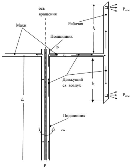
Рисунок 2 – Естественная вентиляция воздуха, вследствие работы центробежных сил
