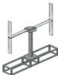
Рисунок 4 – Предварительная конструкция аппарата с системой антиобледенения
