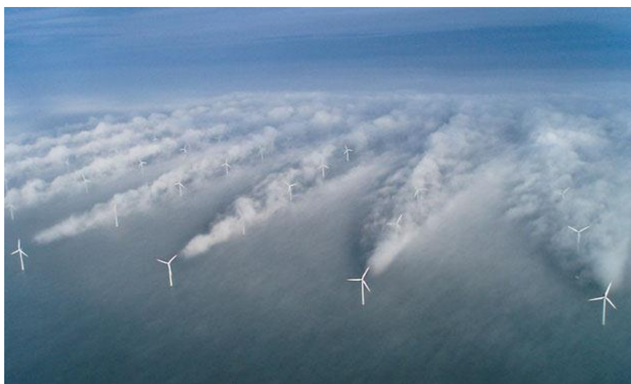
Рис. 5. Картина состояния ветрового потока при пересечении пропеллерных ветротурбин
