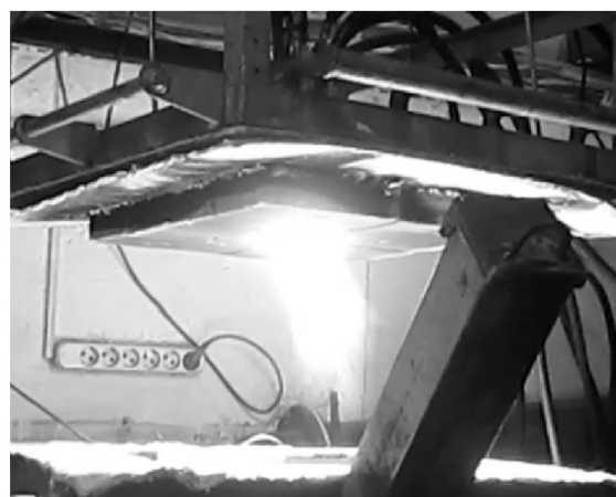
Рис. 3. Плазменный факел от высокоресурсного плазмотрона
