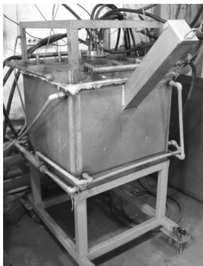
Рис. 2. Экспериментальная установка для плазменной переработки ТБО на опытном стенде НТО "Плазмотехника"
