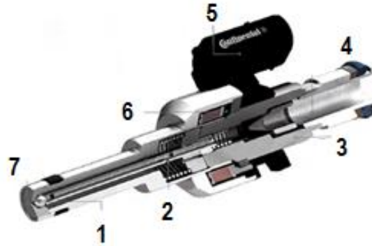
1 – игла, 2 – клапан, 3 – корпус инжектора, 4 – привод топлива, 5 – электрический разъем, 6 – силовой привод, 7 - сопло
