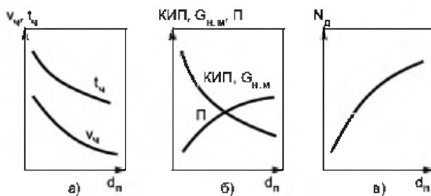
Рис. 1 – Зависимость параметров плазменного напыления: скорости  $V_n$  и температуры  $t_n$  частиц (а), КИП, производительности и пористости покрытия П (б), мощности дуги  $N_d$  (в) от диаметра  $d_n$  частиц порошка
