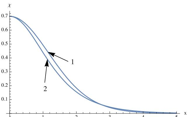
**Рисунок 6** – Профили обычного ( $\varepsilon = +1$ ) скалярного поля  $\chi$  для доменной стенки. Кривая 1 соответствует потенциальному 4-го порядка, кривая 2 – потенциальному 6-го порядка.
