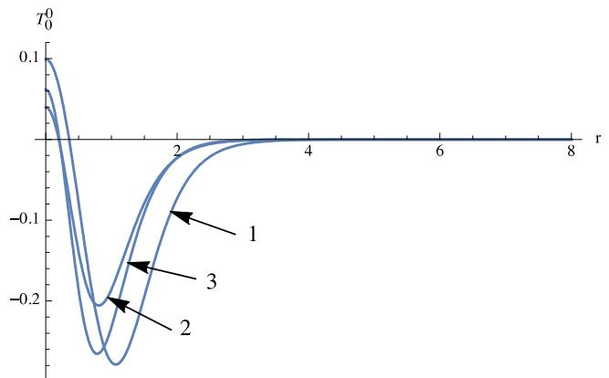
**Рисунок 14** – Профили плотности энергии  $T_0^0(r)$  для проходящей червоточины в случае фантомного скалярного поля. Кривая 1 соответствует потенциальному 4-го порядка, кривая 2 – потенциальному 6-го порядка, кривая 3 – потенциальному 8-го порядка.
