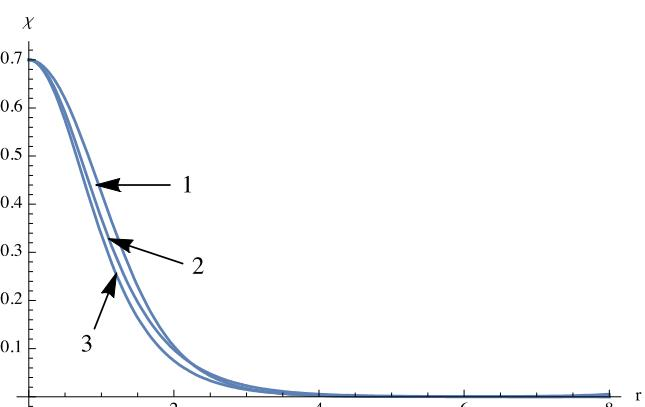
**Рисунок 16** – Профили фантомного скалярного поля  $\chi$  для проходимой червоточины. Кривая 1 соответствует потенциальному 4-го порядка, кривая 2 – потенциальному 6-го порядка, кривая 3 – потенциальному 8-го порядка.
