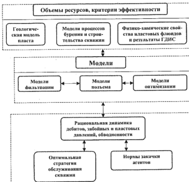
Рис. 1.4. Сущность применения системного подхода в нефтедобыче
