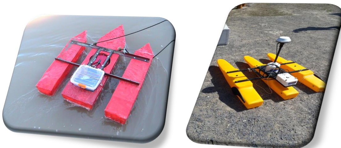
Сурет 5. «Rio Grande», «Stream Pro» акустикалық доплерлік профилографтары.
