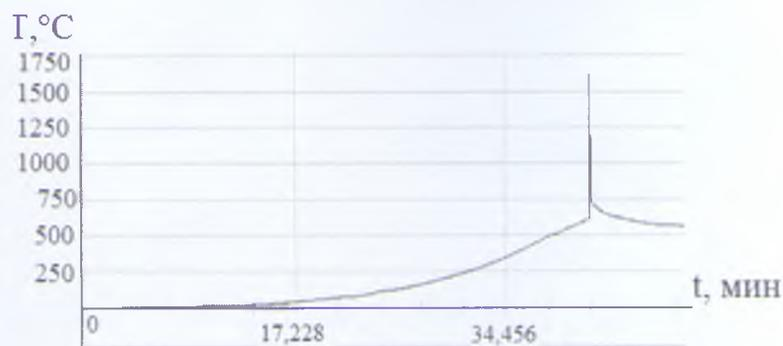
Рис. 2 – Термограмма системы  $\text{TiO}_2 + \text{Mg} + \text{B}_2\text{O}_3(\text{руда})$
