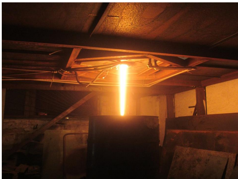
Рисунок 2 – Струя расплава шихты, состоящей из смеси базальта и хромового шлама
