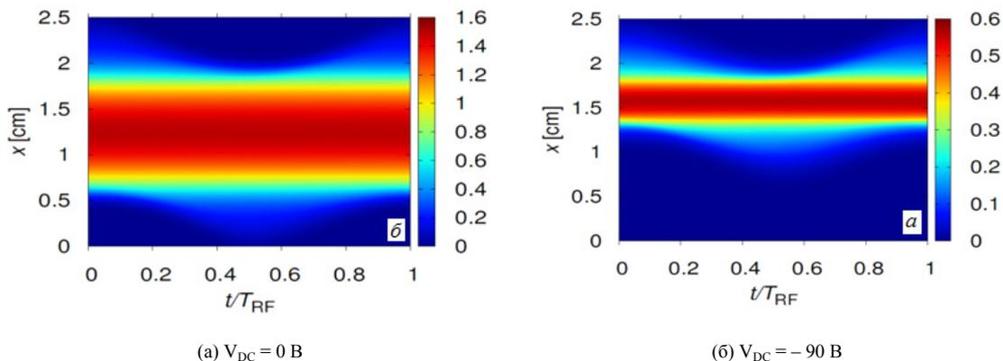
**Рисунок 3** – Влияние постоянного напряжения  $V_{DC}$  на пространственно-временное распределение плотности электронов для  $L = 25$  мм,  $V_{pp} = 150$  В при давлении  $p = 10$  Па. Цветовые масштабы приведены в единицах  $10^9$  см<sup>-3</sup>
