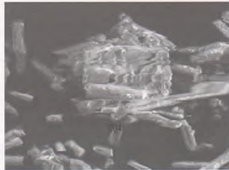
Рис. 3 – Фотография поверхности стеклотканых нитей, свободную от фаз нанесенных компонентов в режиме вторичных электронов (SEI) и микрорентгенограмма поверхности
