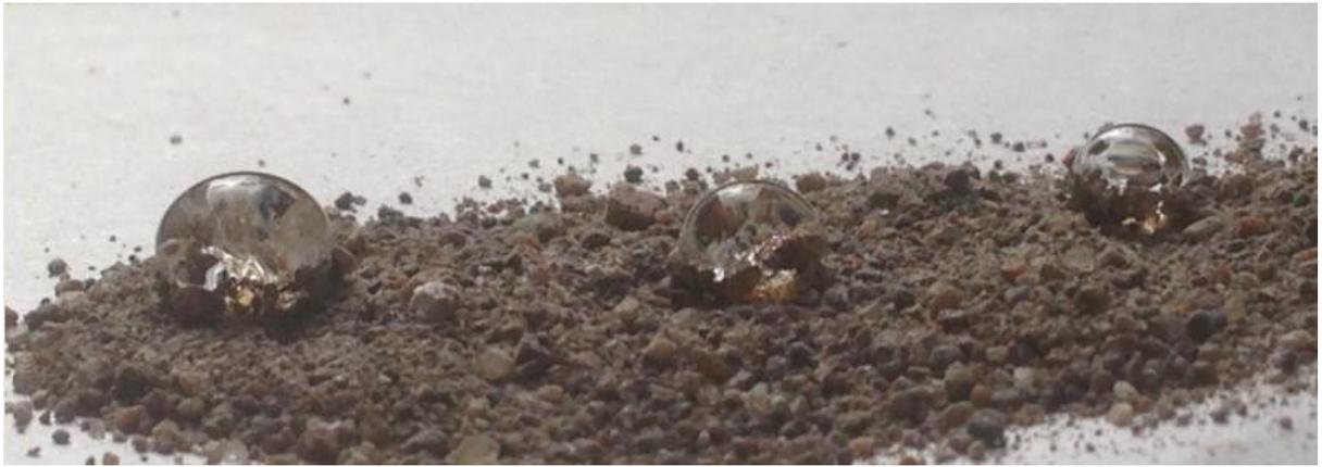
*Рис.5 – Капли воды на поверхности гидрофобного песка*
