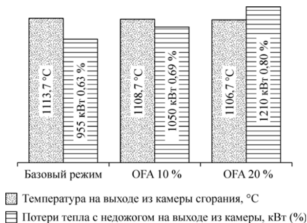
Рис. 13. Влияние OFA на температуру на выходе из камеры сгорания и на потери тепла с недожогом.
