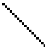
Рисунок 11. Растеризованное изображение, полученное алгоритмом Брезенхема с 8-ми связной разверткой
