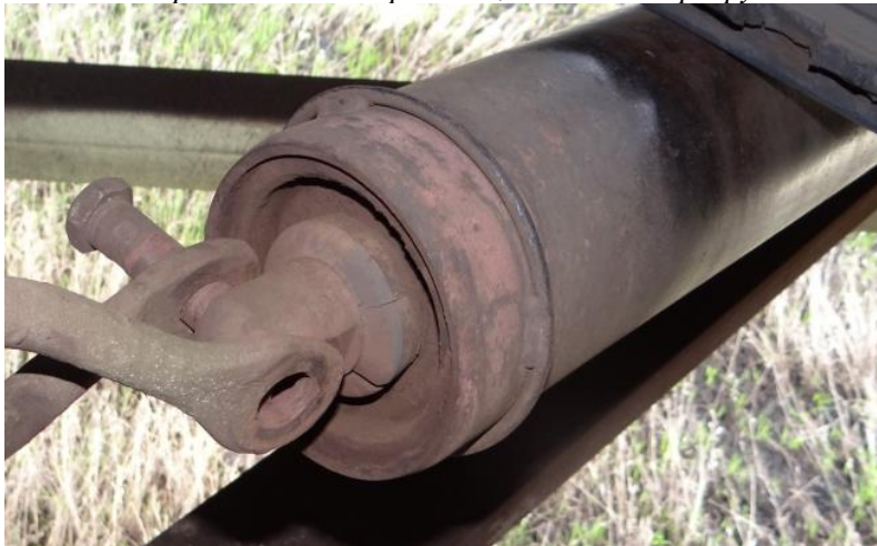
Рисунок 3. Обрыв роликоопоры из-за раскручивания элементов болтовых соединений
