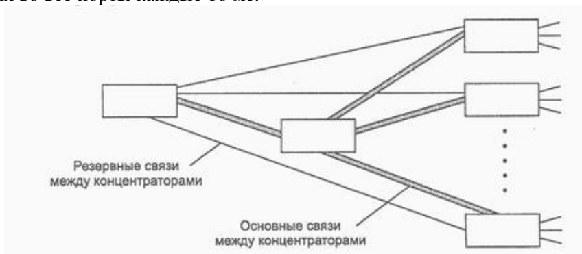
Рис. 3. Резервные связи между концентраторами Ethernet
