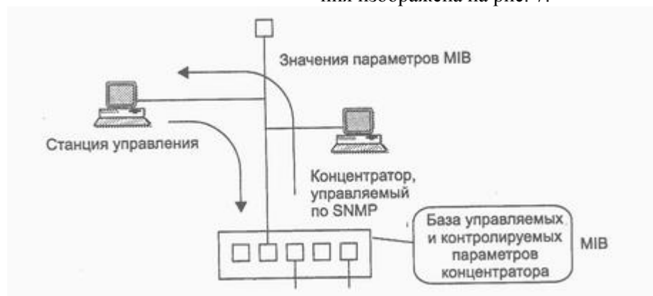
Рис. 7. Структура системы управления на основе протокола SNMP
