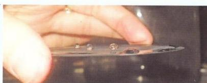
Рис. 2 – Капли воды на сажевой поверхности синтезированной на кремниевой подложке
