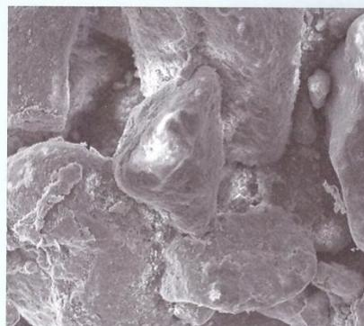
Рис. 4 – Электронно-микроскопические снимки образцов гидрофобного песка
