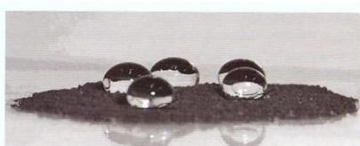
Рис. 3 – Капли воды на поверхности гидрофобного песка
