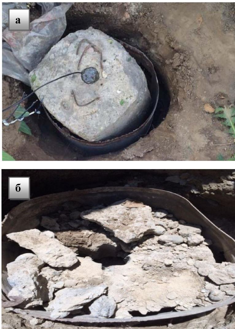
Рисунок 1 – Разрушения бетонных блоков закрытыми броневой оболочкой: а – монолитный бетонный блок; б – монолитный бетонный блок разрушенный ГХП
