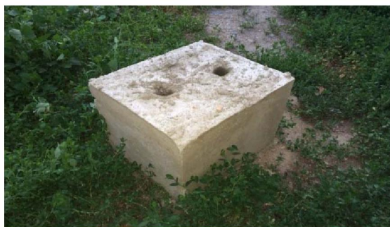
Рисунок 6 – Железобетонная колонна с 2-мя шпурами для ввода газогенератора, работающего в режиме низкоскоростной детонации и невзрывчатой расширяющейся смеси
