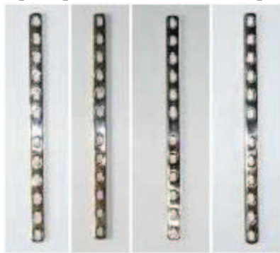
Пластины для остеосинтеза с нанесенным нанокластерным покрытием
