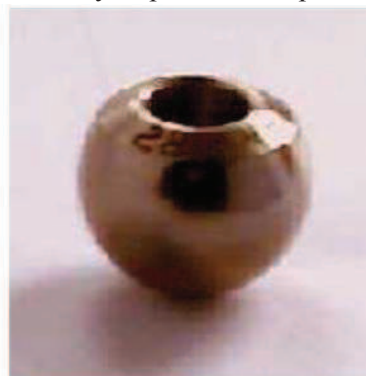
Элемент эндопротеза тазобедренного сустава с нанесенным нанокластерным покрытием. Покрытие выполнено в НТЦ "Нанокластер"
