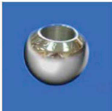
Элемент эндопротеза тазобедренного сустава (компания "ЗАО ТРЕК-Э Композит") без нанокластерного покрытия
