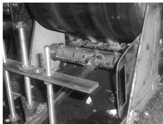
Рис. 4. Фотография процесса получения супергидрофобной сажи с использованием никелевого катализатора сотового типа
