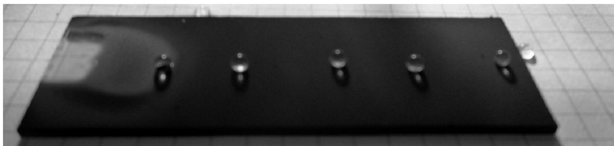
Рис. 13. Фотографии, иллюстрирующие поведение капель воды на поверхности стеклянной кварцевой подложки с нанесенным слоем сажи
