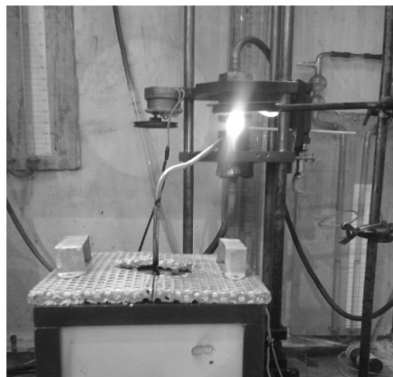
Рис. 5. Фотография установки для сжигания полиэтиленовых отходов
