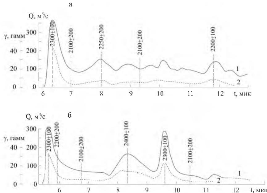
Рисунок 4 – Изменение расхода селевого потока (1) и напряженности магнитного поля во времени (2).
