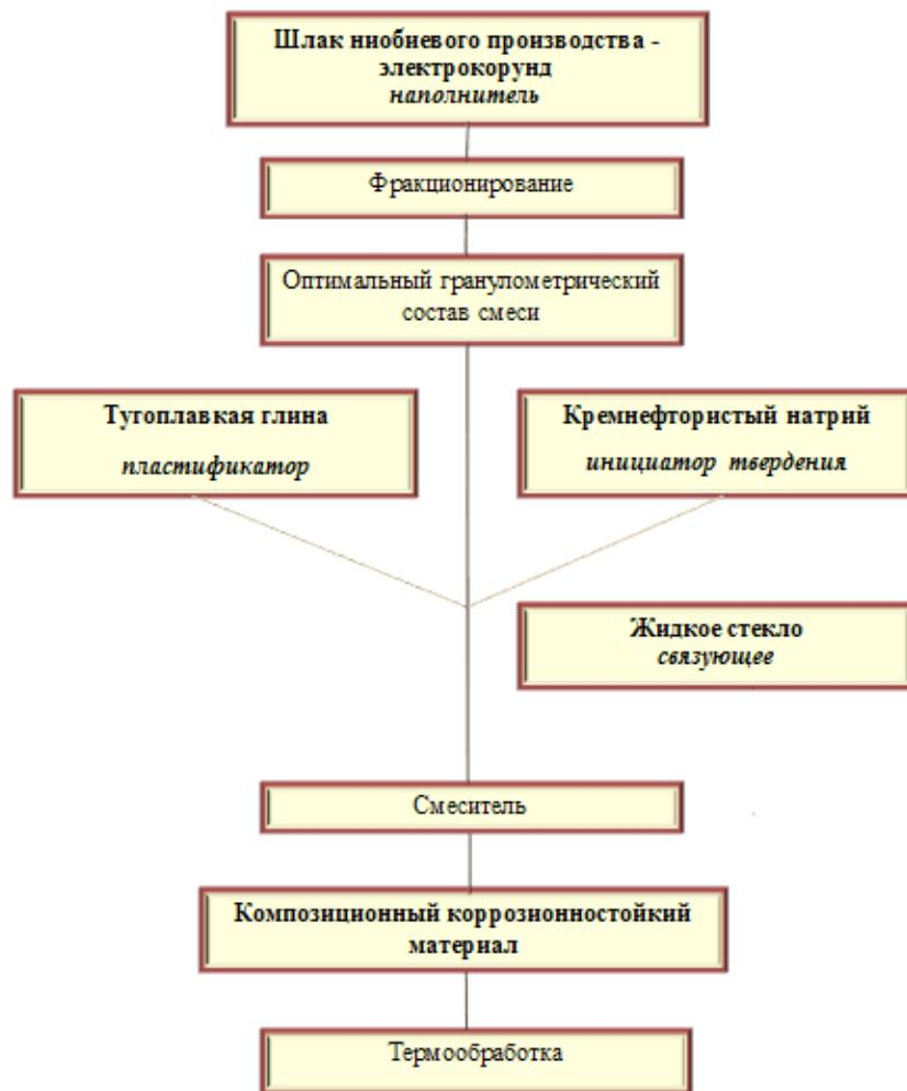
Рисунок 4 – Технологическая схема приготовления композиционных КМ
