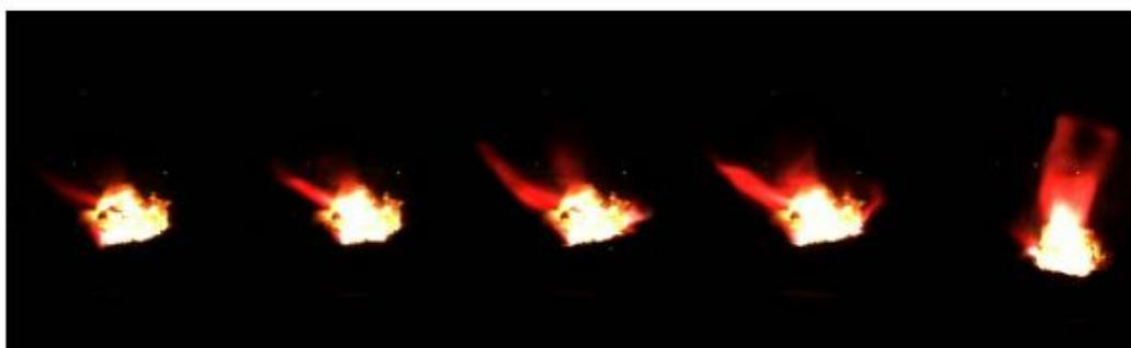
2 -  $\text{NH}_4\text{ClO}_4 + \text{Sr}(\text{NO}_3)_2 + \text{Mg} + \text{фенольная смола}$ , скорость горения - 2,36 мм/с
