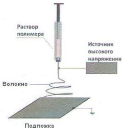
Рис. 1 – Схематическое изображение установки для электропрессинга
