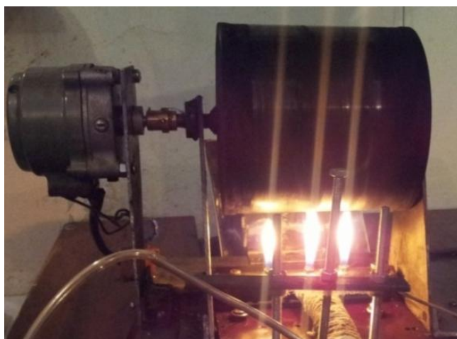
Рис. 2 – Фотография установки для исследования процесса синтеза супергидрофобной сажи с наложением электрического поля
