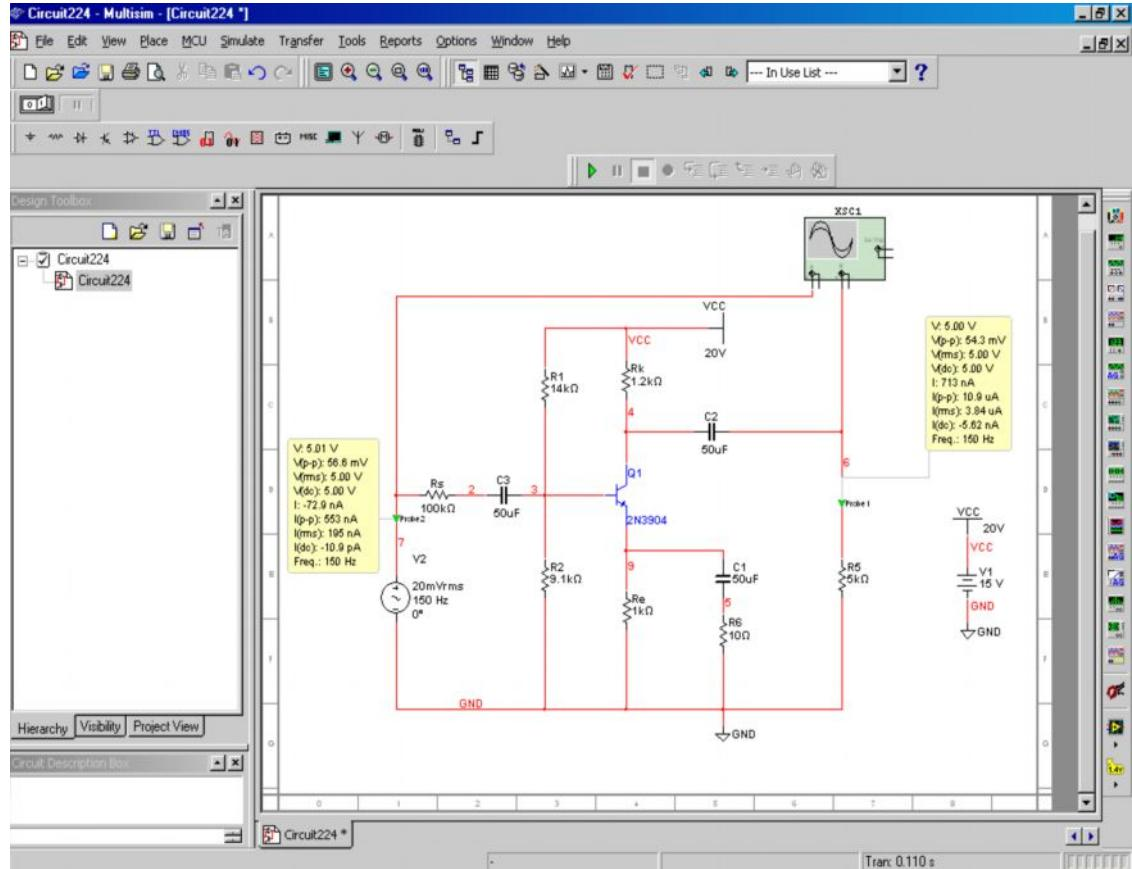
2) Запускаем схему, осциллограф автоматически строит графики зависимости входного и выходного напряжений от времени (для того, чтобы их посмотреть, достаточно нажать левой кнопкой мыши на осциллографе).
