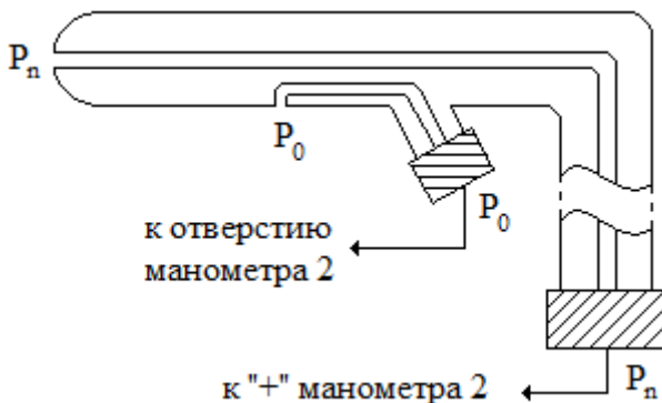
Рис. 9. Схема подсоединения трубки Прандтля к микроманометру
